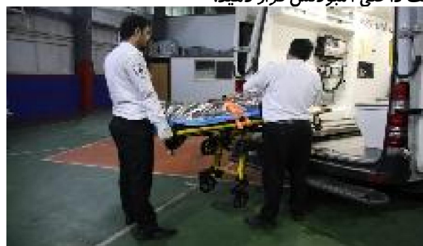
■ b ۶-۶ هنگامی که چرخ‌ها به طور ایمن روی کف آمبولانس قرار گرفتند، امدادگر در عقب اهرم را فعال می‌کند تا چرخ‌ها آزاد شوند. (این کار ممکن است نیاز به کمی بلند کردن برای برداشتن وزن از روی چرخ‌ها، داشته باشد.) در صورت لزوم، امدادگر دوم برانکار در حال افتادن را هدایت می‌کند.
