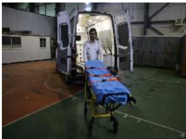
■ ۶-۷ تخت باریاتریک Stryker MX-PRO®، بیماران با وزن ۷۲۵-۳۸۵ کیلوگرم را حمل می‌کند و می‌تواند با ابزار بالابر رمپ استفاده شود.
